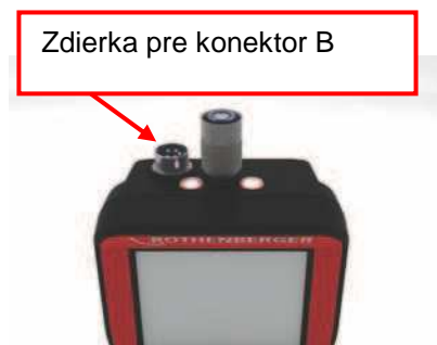
Obrázok 5 – Pripojenie kábla (konektor typ B, strieborný)
