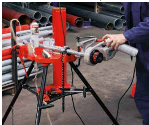
Řezání závitu na univerzálním pracovním stole s trojnožkou
