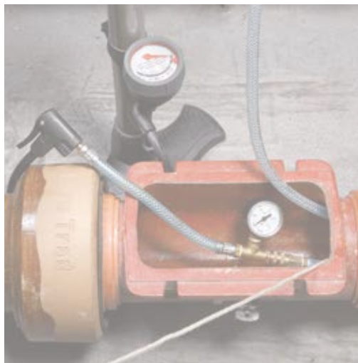
Zkušební sada domovních přípojek při použití
