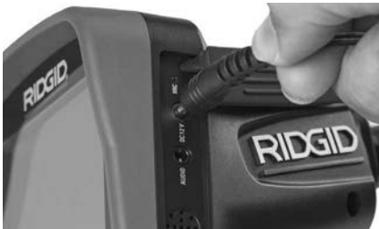
Εικόνα 6 - Τροφοδοσία της μονάδας με αντάπτορα AC
