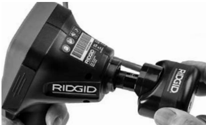
Figure 18 – Connexion du câble de tête de caméra
