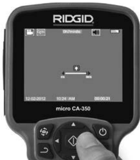
Figura 14 - Ajustar o LED
