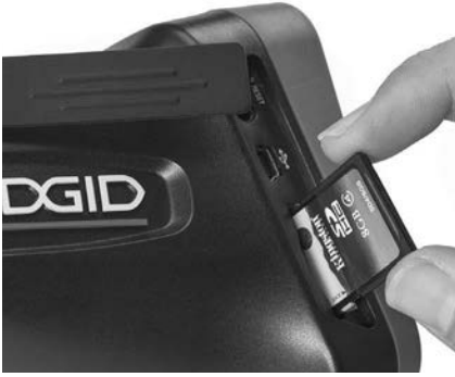
Şekil 9 - SD Kartın Takılması
