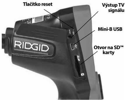
Obrázek 4 – Kryt vstupů na levé straně
