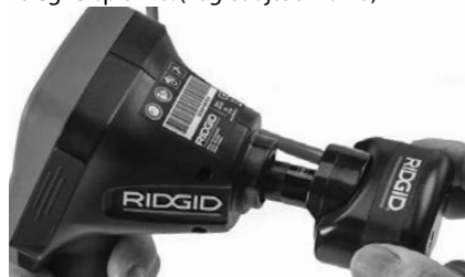
Slika 18 - Ugrađen konektor kamere
