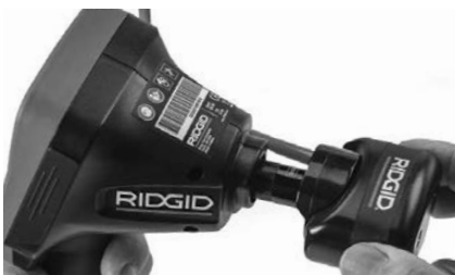
Figura 18 - Fișa conectoare a camerei instalată
