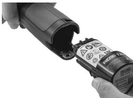
Obrázok č. 5 - Montáž/demontáž akumulátora
