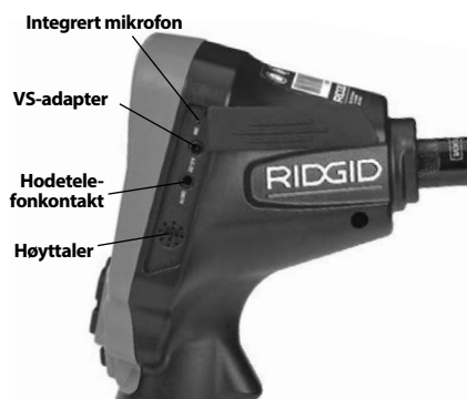
Figur 3 – Portdeksel på høyre side
