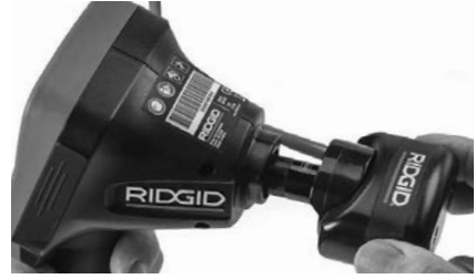
Şekil 18 - Kamera Bağlantı Parçası Fişi Takılı
