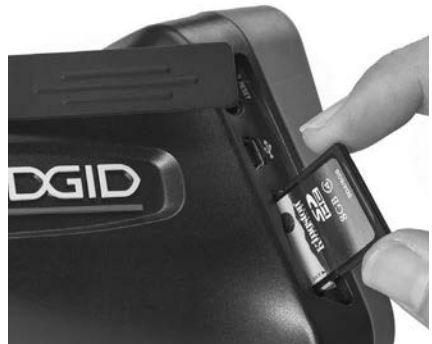
Abbildung 9 - Einsetzen der SD-Karte
