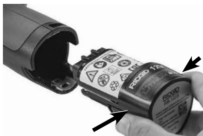
Figura 5 – Remove/instalar a Bateria
