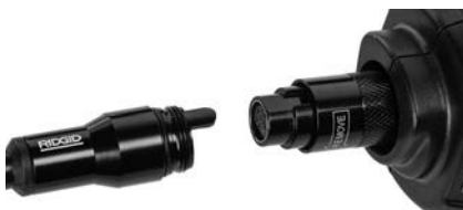
Figura 7 – Conexión del cable al visualizador
