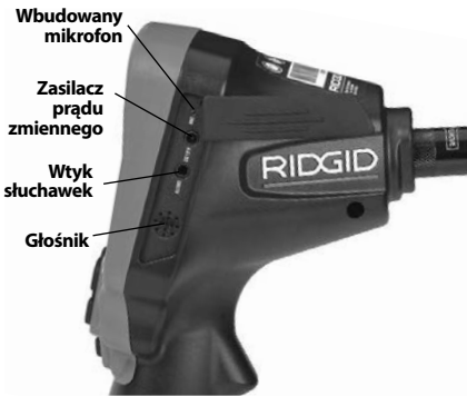
Rys. 3 - Pokrywa gniazd po prawej stronie
