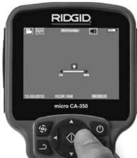
Rys. 14 - Regulacja diod LED
