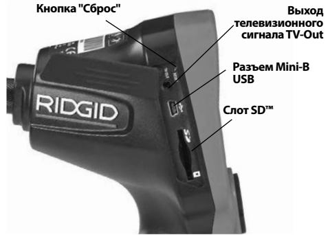
Рис. 4 - Крышка гнезд с левой стороны прибора
