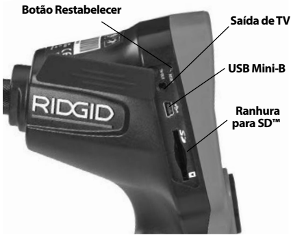
Figura 4 - Tampa da Porta Lateral Esquerda
