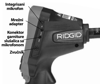
Slika 3 - Poklopac priključaka sa desne strane uređaja
