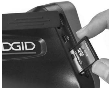
Rys. 9 - Wkładanie karty pamięci SD
