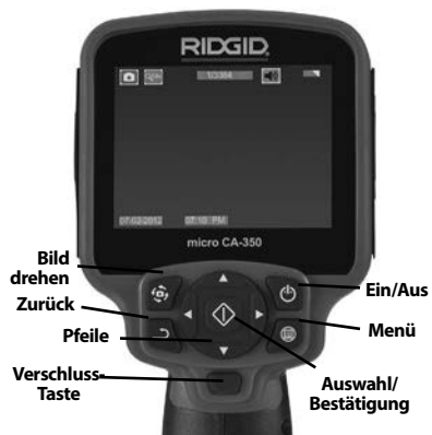
Abbildung 2 - Bedienelemente der Display-Einheit
