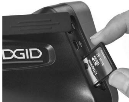
Figuur 9 – De SD-kaart installeren
