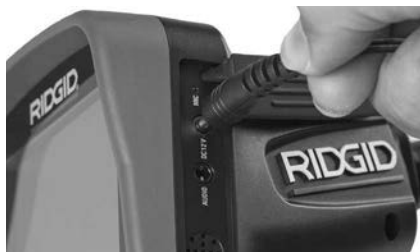
Slika 6 - Napajanje uređaja pomoću AC adaptera
