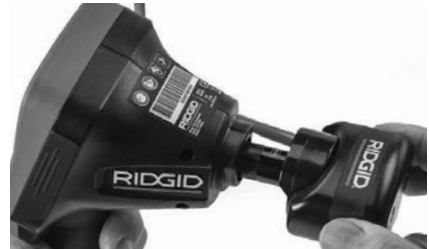
Abbildung 18 - Mit eingebautem Kameraanschlussstecker
