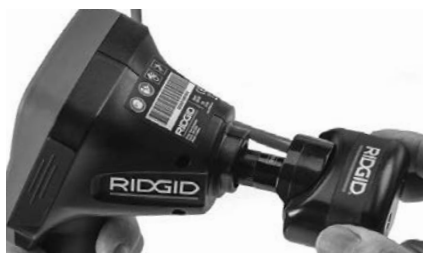
Obrázek 18 – Připojený konektor kamery
