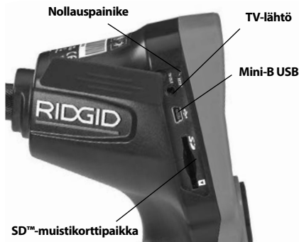
Kuva 4 – Vasemman puolen portin suojus
