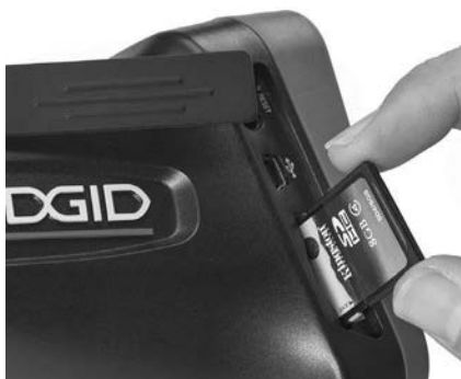
Figura 9 – Inserimento della scheda SD
