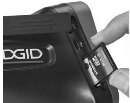
Figura 9 - Introducere cardului SD
