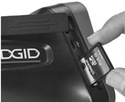
Slika 9 - Umetanje SD kartice
