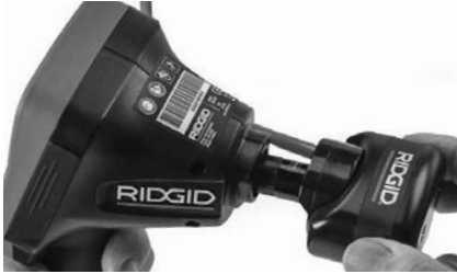
18. ábra – Kamera csatlakozódugója beszerelt állapotban
