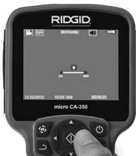
Obrázek 14 – Nastavení LED osvětlení
