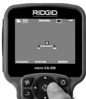
Figura 14 – Ajuste de los LED
