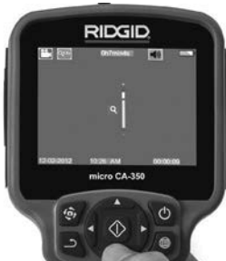
Rys. 15 - Regulacja funkcji zoom
