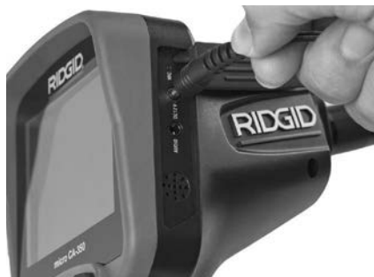
Figur 6 – Driva enheten med nätadaptern
