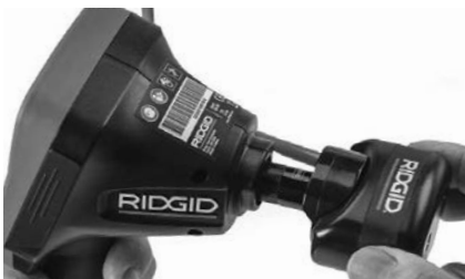
Figura 18 - Ficha do Conector da Câmara Instalada
