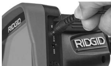
6. ábra – A műszer működtetése AC adapterrel
