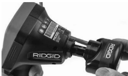
Figur 18 – Kamerans anslutningskontakt ansluten
