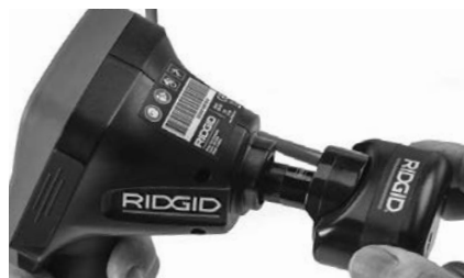
Figura 18 - Spina connettore fotocamera installata
