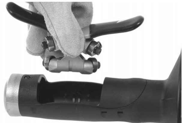
Obrázek 12B – Vyjímání mechanismu AUTOPOSUVU ze skříně
